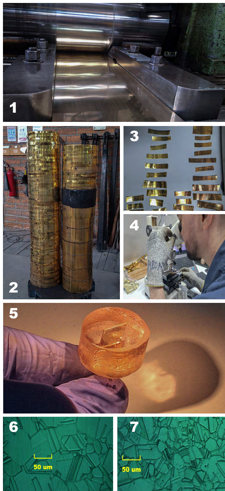
1. Proceso de laminado en frío. 2, 3, 4. Disposición del material y toma de muestras para análisis de durezas. 5. Probeta para análisis de tamaño de grano. 6, 7. Tamaño de grano sin manta vs con manta.
