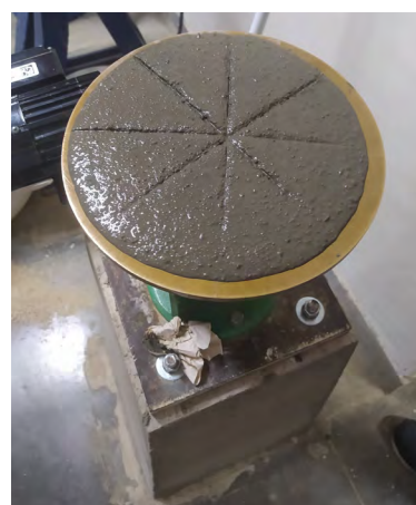
Prueba de fluidez de morteros
